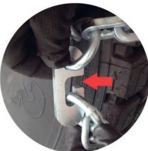
**DE** Schneeketten neben dem Rad ausbreiten und ordnen. Spannhebel und Spannkette nach außen positionieren. Innenkette fassen und die Schneekette auf den Reifen auflegen, das Laufnetz mittig positionieren und gleichmäßig auf dem Reifen verteilen.
