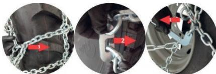
**DE Passform anpassen:** Die Passform der Kette kann durch Kürzen der Innenkette verändert werden. Mittels Schäkel kann die Länge der Innenkettenabschnitte variiert werden. Die Verkürzungsstellen gleichmäßig verteilen – die einzelnen Innenkettenteile sollen nach dem Verkürzen möglichst gleich lang sein.
