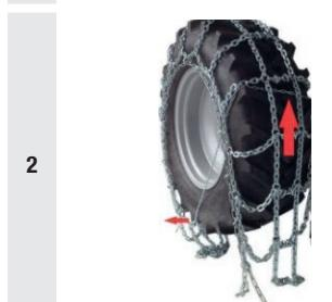
**DE** Langsam eine Radumdrehung fahren, Kette zieht sich dabei auf den Reifen. Schneekette von Montagekette/-seil lösen. Montagekette/-seil herausziehen.
