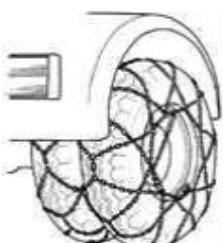
**DE** Die Spannkette einziehen, vorspannen und den Spannhebel in das nächste erreichbare Glied der Spannkette einführen. Spannhebel umlegen und mit Ring sichern. Spannkette in Seitenkette sichern. **Nach etwa 100 m Fahrt Sitz der Kette prüfen und wenn nötig nachspannen!**
