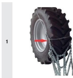
**DE** Schneeketten vor oder hinter dem Rad ausbreiten und ordnen. Spannhebel und Spannkette nach außen positionieren. Montagekette/-seil über die obere Hälfte des Reifens legen und die Kette an den Montagehaken einhängen.
