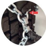
**FR** Soulever la fermeture de sécurité centrale et l'accrocher dans l'anneau muni d'une entaille.
