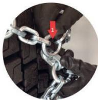
**DE** Mittelverschluss/Lauflächenhaken anheben und in den Ring über die Flachstelle einhängen.
