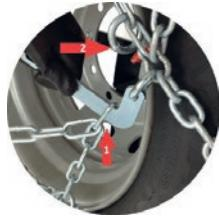
**DE** Mittelstränge durch die Endringe ziehen und mit den Schäkeln an der Seitenkette befestigen.
