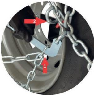
**DE** Die Spannkette einziehen, vorspannen und den Spannhebel in das nächste erreichbare Glied der Spannkette einführen. Spannhebel umlegen und mit Ring sichern. Spannkette in Seitenkette sichern. **Nach etwa 100 m Fahrt Sitz der Kette prüfen und wenn nötig nachspannen!**
