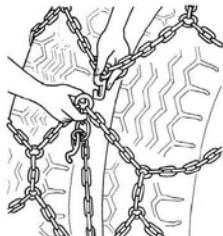
**DE** Den Mittelhaken der Kette in den entsprechenden Ring einhängen. Den Mittelteil der Kette mit der dafür vorgesehenen Spannkette spannen.
