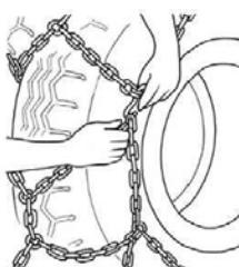
**DE** Die Kette hinter den Antriebsrädern ausbreiten. Montagekette/-seil auf beiden Reifen auflegen und die Schneekette mit den Verschlussheksen befestigen. Kontrollieren Sie, dass sich die Spannkette am Außenreifen befindet und dass die Mittelspannkette nach innen gewandt ist.
